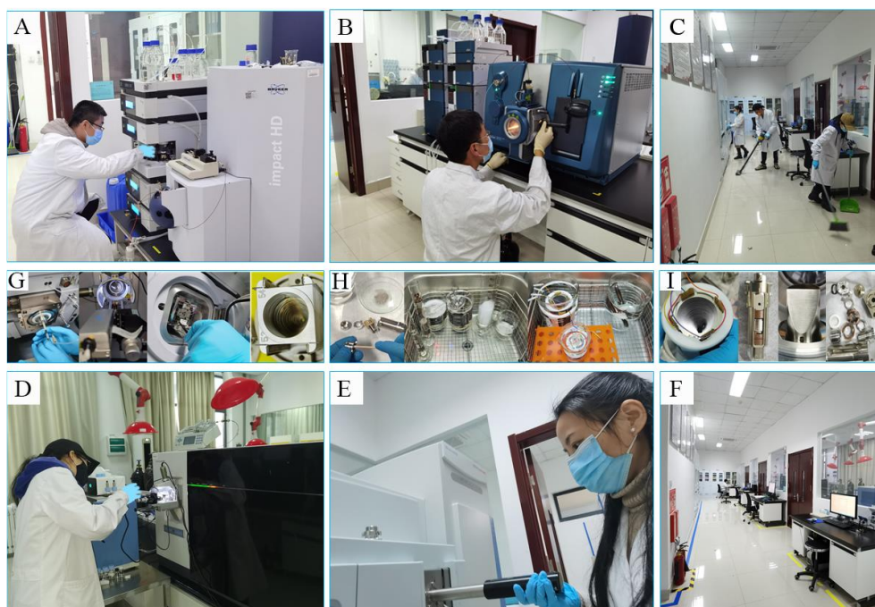
图 2. 质谱技术团队的老师对质谱仪的维护保养。A-B&D-E. 质谱仪的拆装维护校正(备注：质谱室运行温度偏低，室内长期工作人员即使在夏季也需要穿秋冬衣避风防寒)；G-I. 质谱仪腔内元件清洗维护(G. 清洗前；H. 清洗中；I. 清洗后)；C&F. 质谱操作室环境维护 (C. 清理中，F. 清理后)
