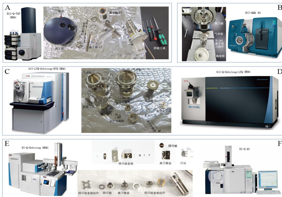
图 1. 质谱仪及其内部需清洗维护的电子元件 A. 四极杆飞行时间高分辨质谱仪 (ESI-Q-TOF MS, Bruker impact HD); B. 三重四极杆质谱仪 (ESI-QQQ MS, SCIEX QTRAP 5500+); C. 线性轨道阱电子转移解离裂解源高分辨质谱仪 (NSI-LTQ-Orbitrap-ETD MS, Thermo Orbitrap Velos Pro); D. 纳升三合一高分辨质谱仪 (NSI-Q-LTQ-Orbitrap Tribrid MS, Thermo Orbitrap Fusion Lumos ); E. 气相高分辨质谱仪 (EI-Q-Orbitrap, Thermo Q Exactive GCMS ); F. 气相质谱仪 (EI-Q, Shimadzu GCMS-QP2010Plus)
